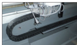
· Disposizione dei collegamenti tramite catena
