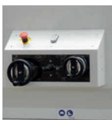
Joystick · Volantini per il funzionamento manuale · Arresto di emergenza · Tasto di conferma
